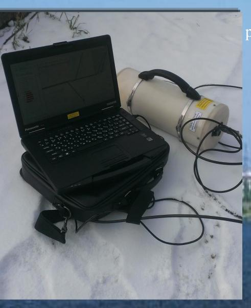
Комплекс спектрометрический СКС-07П-Г41 установки радиационной гамма-съемки на местности состоит из: блока детектирования гамма-излучения БДЕГ - 63(63)Н; цифрового многоканального анализатора МКА-01-00; капсулы переносной
