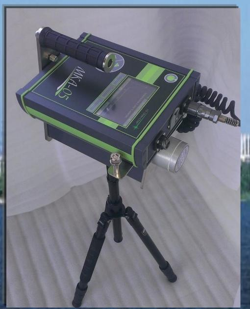
Измерение акти вности образцов по гамма-излучению автономном режиме, расчет активности счетных образцов, расчет МАЭД по результатам гаммаспектрометрического контроля
